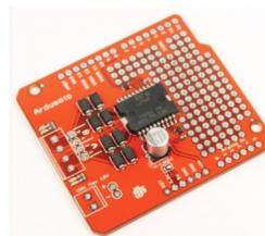
**Shield de puissance pour 2 moteurs à courant continu**
