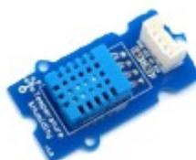
**Capteur d'humidité et température**
