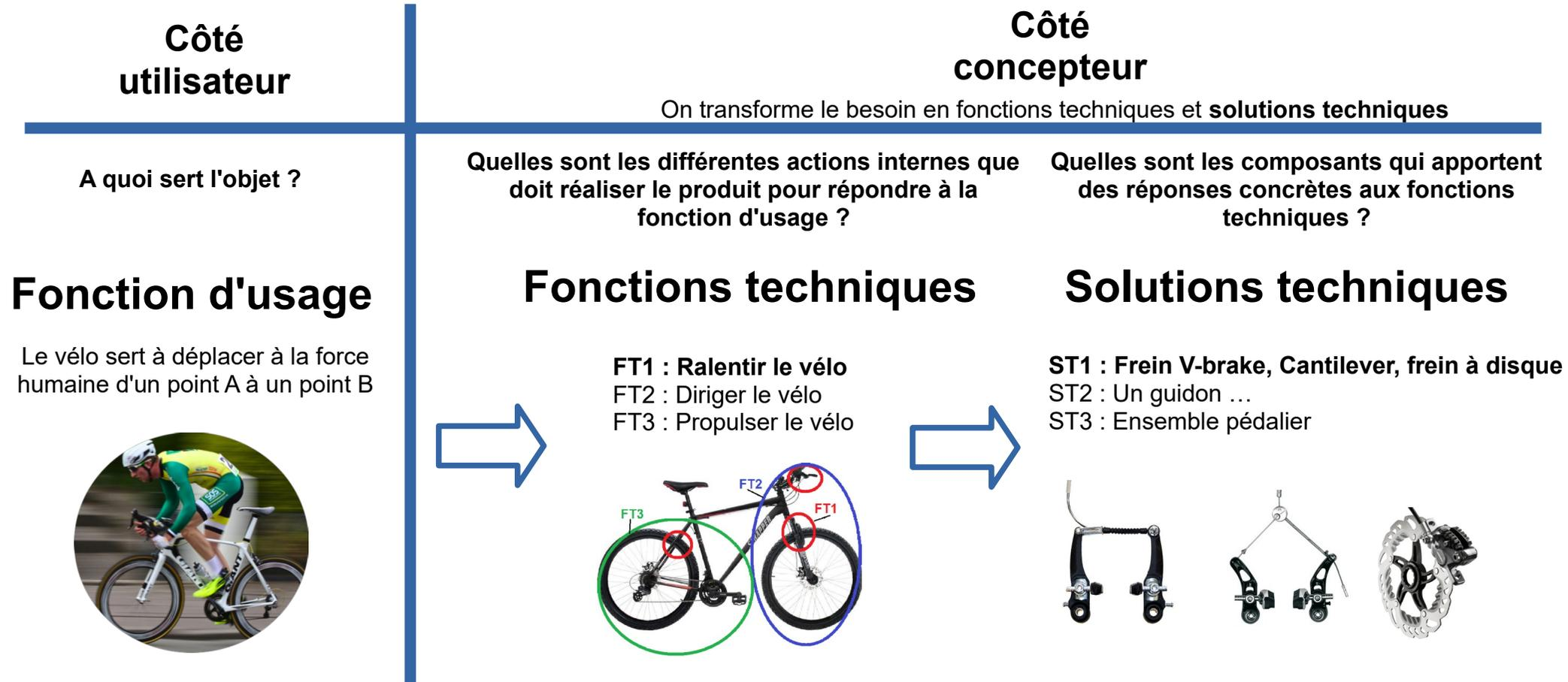
C'est l'association de toutes les fonctions techniques de l'objet qui permet de réaliser la fonction d'usage et d'obtenir l'objet technique qui correspond au besoin. Ces fonctions techniques sont réalisées en utilisant des solutions choisies parmi plusieurs différentes.
